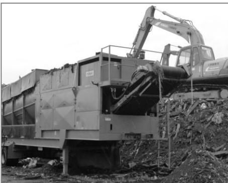
がれきの選別は重機に始まり最終的には手作業で行っています。
